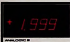
spanning DC 20,00 mV v.s. tot 1000V v.s.
