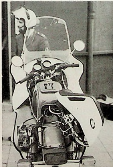
In de politie-motoren van Nordrhein-Westfalen is een radio-telefonie-apparaat FuG8a onder het zadel gemonteerd, zó, dat noch de bewegingsvrijheid van de bestuurder noch de rij kwaliteiten van het voertuig worden beïnvloed.
