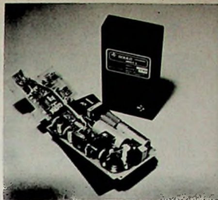
Afb. 5. Opbouw van een miniatuurvoeding voor 30 W.
